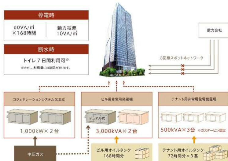
停電時の電力供給システム概念図
